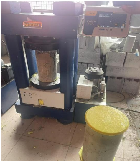
Figure 28: Ecrasement du béton : (a) machine de compression ; (b) état du béton après écrasement
