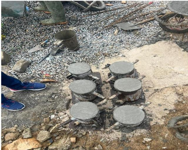
**Figure 16 : prélèvement des 6 éprouvettes bétons pour les essais de compression**
