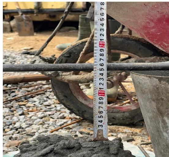
**Figure 15: l'essai a l'affaissement au cône d'Abrahams**
