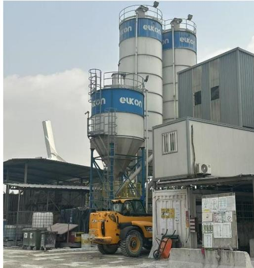
Figure 34: Centrale à béton du chantier
