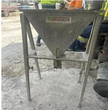
Figure 43: viscosimètre
