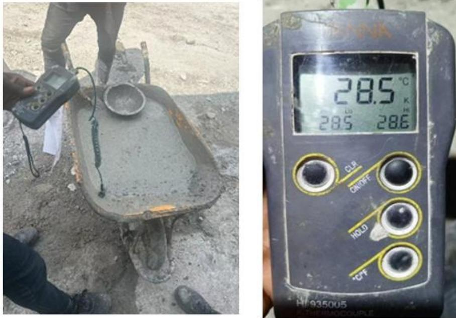
Figure 41 : Prise de la température avant le départ de la toupie
