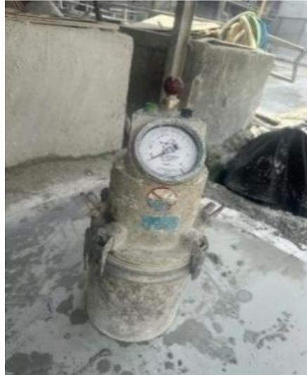
Figure 40: Aéromètre de pression
