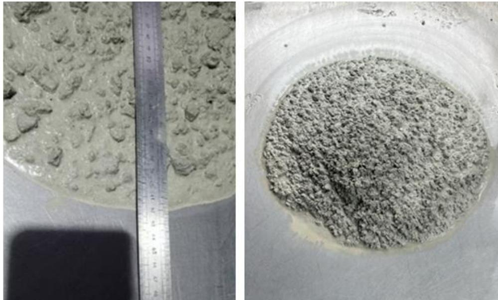
Figure 42 : Mesure de l'étalement
