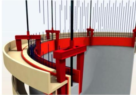
Figure 22: Vue sur les armatures dans un système de coffrage glissant
